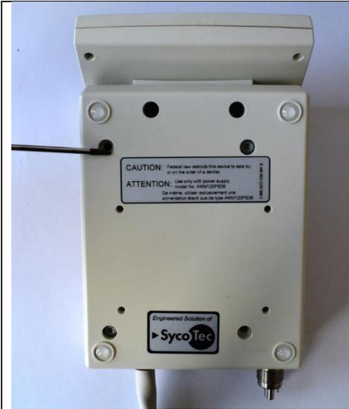
Am Steuergerät 6x Halbrundschaube (Pos.19) lösen mit Schraubendreher Torx T8 (Pos.20)
