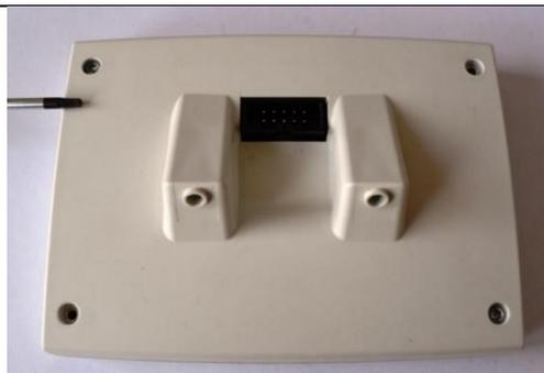
Am Display 4x Halbrundschaube (Pos.18) lösen mit Schraubendreher Torx T8 (Pos.20)
