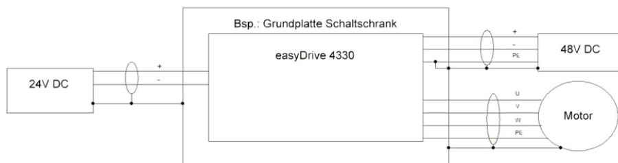
Die Geräte dürfen nicht direkt an Niederspannungsversorgungsnetze angeschlossen werden.
